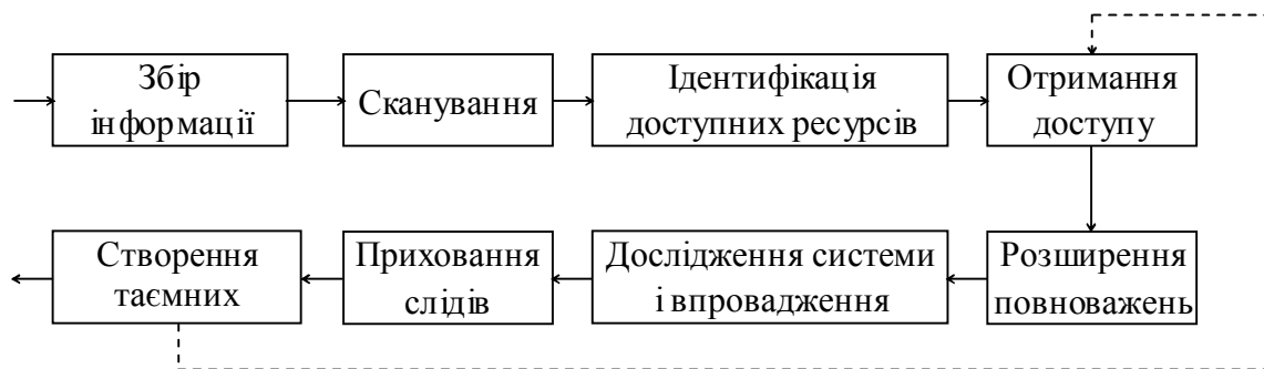
Рис. 3. Схема НСД до ІТС при віддаленому доступі
