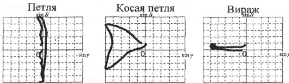
Рис. 2. Зображення кутів крену і тангажа при виконанні фігур пілотажу
